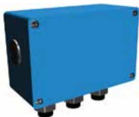
Kleiner Aluminium-Klemmenkasten für die Baugrößen 280 - 450 (Variantencodes 418, 568, 380, 569) Die Größe des anhand dieser Codes bestellten Klemmenkastens hängt von der Anzahl der bestellten Hilfseinrichtungen ab. 80 x 125 mm, max. 12 Klemmenleisten. Erdungsschraube M4
